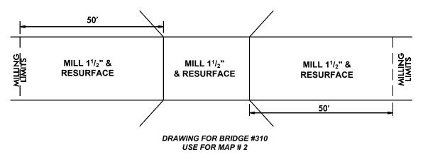
\* MILLING SHALL BE PAID FOR UNDER INCIDENTAL MILLING
